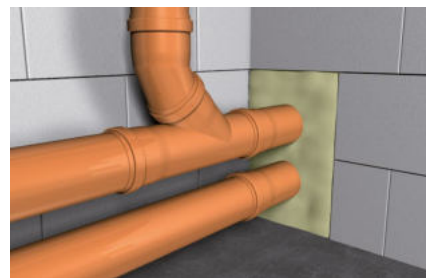
Wypełnianie prześwitów i bruzd dla rur
