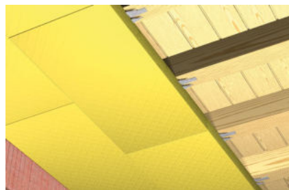
Sztywne płyty izolacyjne mocowane od spodu stropu
